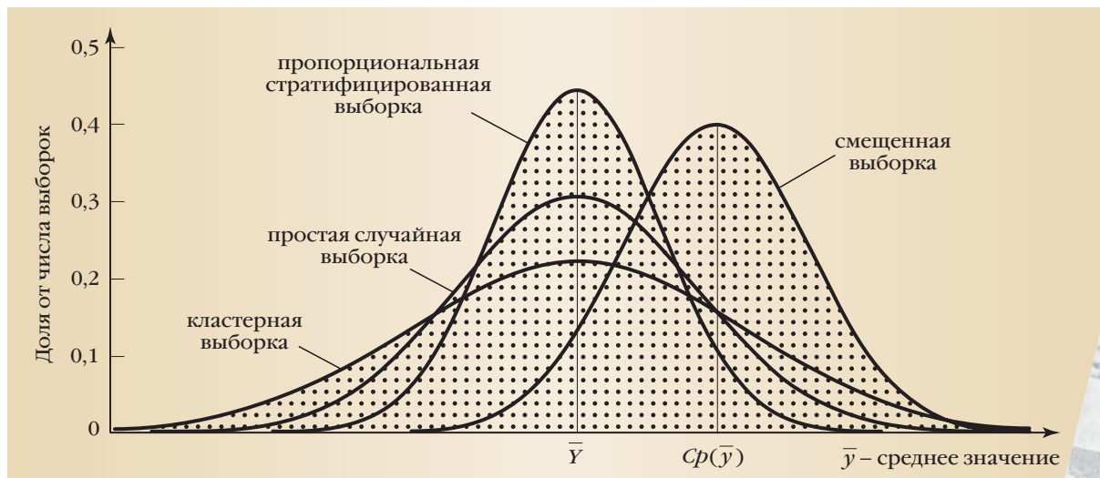
Рис. 2. Распределение оценки среднего значения параметра \bar{y} для разных типов выборок
